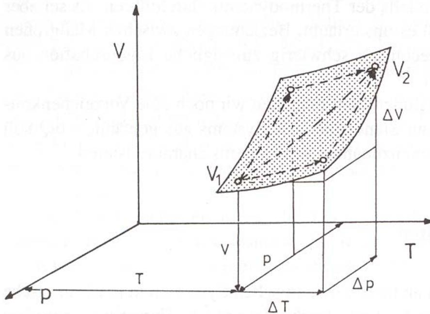
Abhängigkeit des Molvolumens  $V_m$  eines idealen Gases von Druck  $p$  und Temperatur  $T$  als
